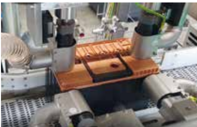
Комплекс для щеточной очистки полюсов АКБ
