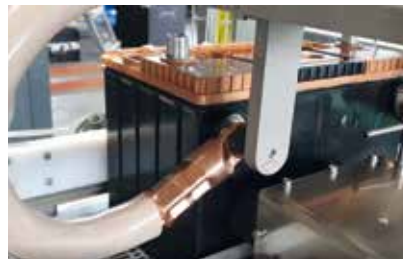
Нагрузочные испытания многоамперным током (PLT)
